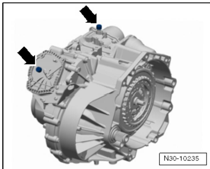
Fissare il cambio al dispositivo -VW 353-
