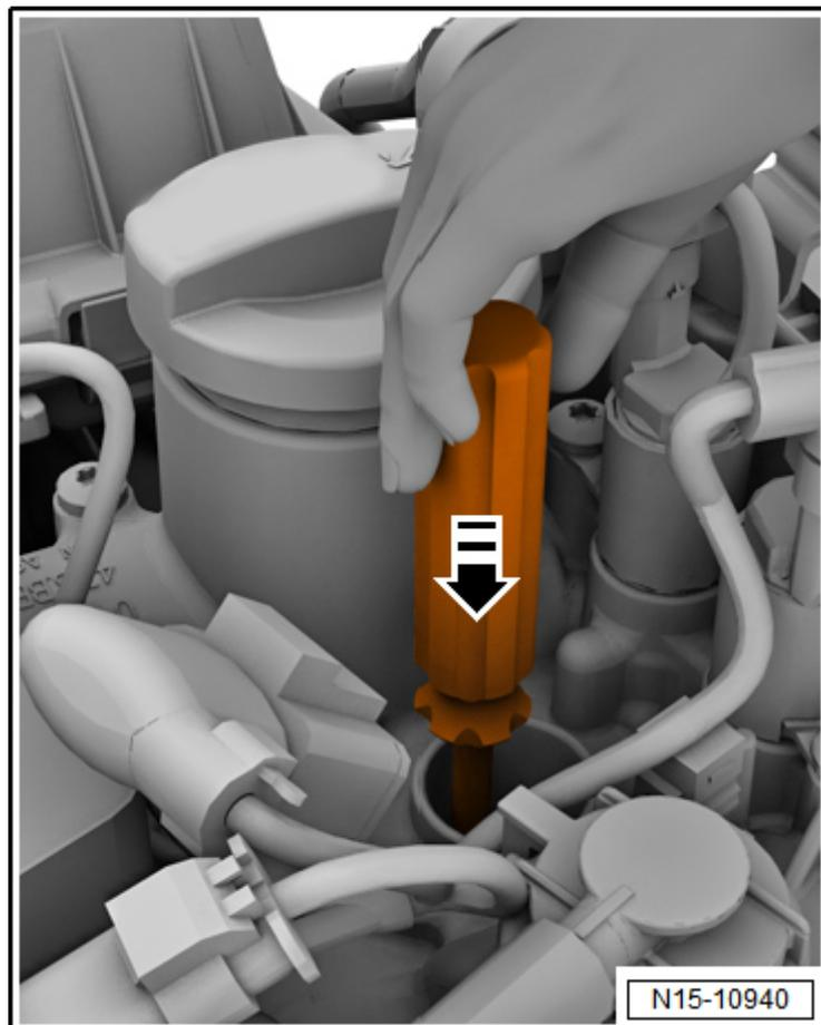
Girare ulteriormente l'albero motore nel -senso corretto di rotazione fino a che il cacciavite non si sposta di -30 mm- nella direzione indicata dalla -freccia-.
