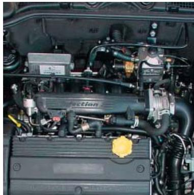
L'avviamento avviene a benzina e, per condizioni di emergenza, esiste l'opzione di avviamento a gas con il commutatore.
