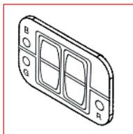
l'allumage contemporain de la couleur verte du LED situé sur le frontal du commutateur. Ceci, pour fournir automatiquement le «starter» pour faciliter le démarrage. Si on démarre avant de la fin du starter, l'alimentation des électrovannes continue, et au contraire elle s'interrompt et se réactive dès que le moteur est démarré.
