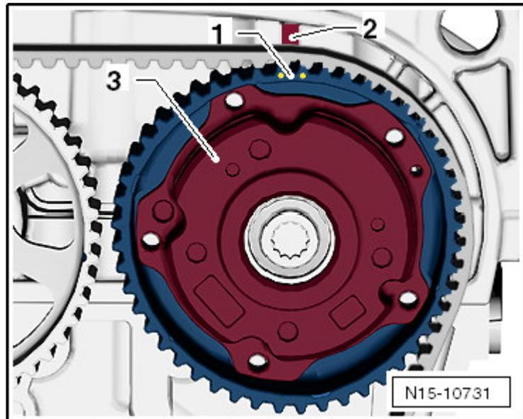
Ruotare l'ingranaggio di comando dell'albero a camme delle valvole di scarico -3- fino a posizionarne il dente contrassegnato -1- di fronte alla sporgenza -2- che si trova sull'alloggiamento degli alberi a camme.
