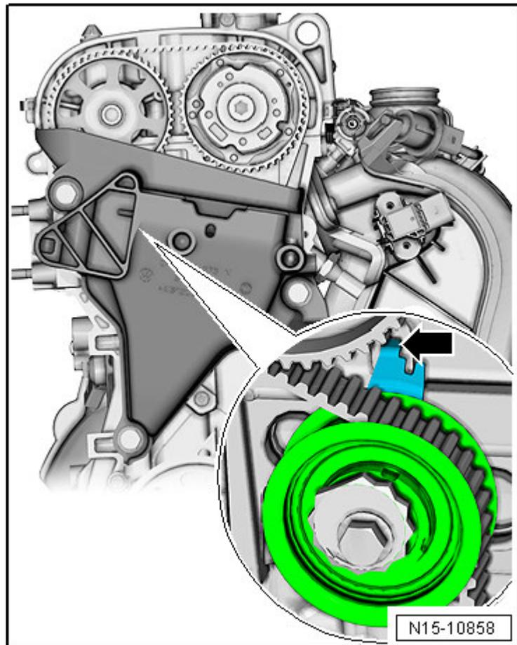
La superficie fresata della ruota dentata -freccia- deve poggiare sulla superficie fresata del perno dell'albero motore.
