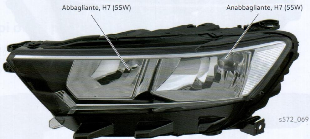
Nei veicoli dotati di fari alogeni le funzioni delle luci di posizione e diurne e degli indicatori di direzione sono realizzate da fari alogeni nel paraurti.
