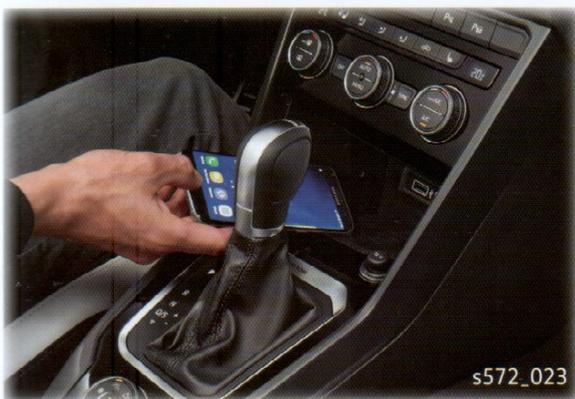
La ricarica dello smartphone può avvenire attraverso la presa USB o mediante la ricarica induttiva. A tal fine lo smartphone compatibile con lo standard Qi deve essere posizionato sul vano portaoggetti davanti alla leva del cambio. Al di sotto del vano portaoggetti vi è il vano portaoggetti con presa per telefono cellulare R625 con le diverse bobine per la ricarica induttiva e l'accoppiamento induttivo dell'antenna.
