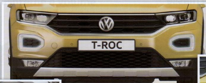
Griglia del radiatore con fari integrati e ampia presa d'aria nonché protezione del sottoscocca trapezoidale
