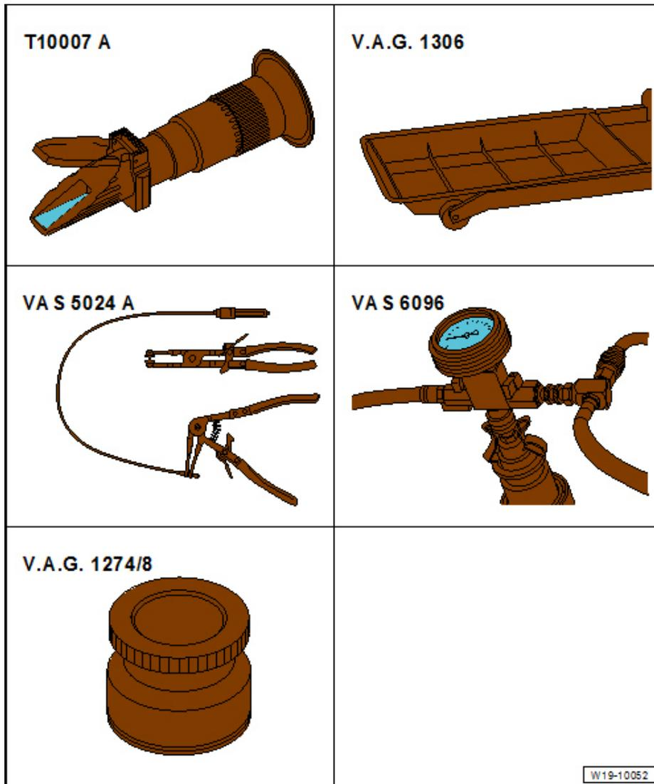
Attrezzi speciali, strumenti di controllo e di misurazione e altri materiali necessari
