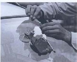
Svitare lo stantuffo di circa tre giri (5-6mm) e versare nel cilindro 3-4 gocce di **resina di riparazione** contenuta nell'apposita pipetta dopo aver tagliato la punta del beccuccio. Richiudere e rimettere la pipetta con la resina nella confezione (busta originale).
