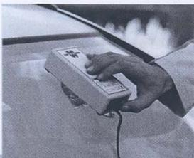
L'indurimento avviene tramite la **lampada a raggi ultravioletti (UV)** che viene fissata all'esterno sul parabrezza mediante le due ventose sopra il punto riparato. Accendere la lampada azionando il pulsante rosso del temporizzatore (Timer).
