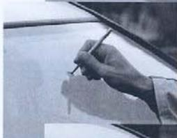
Rimuovere le schegge di vetro dal punto di rottura mediante la **matita con punta in Hartmetall**.
