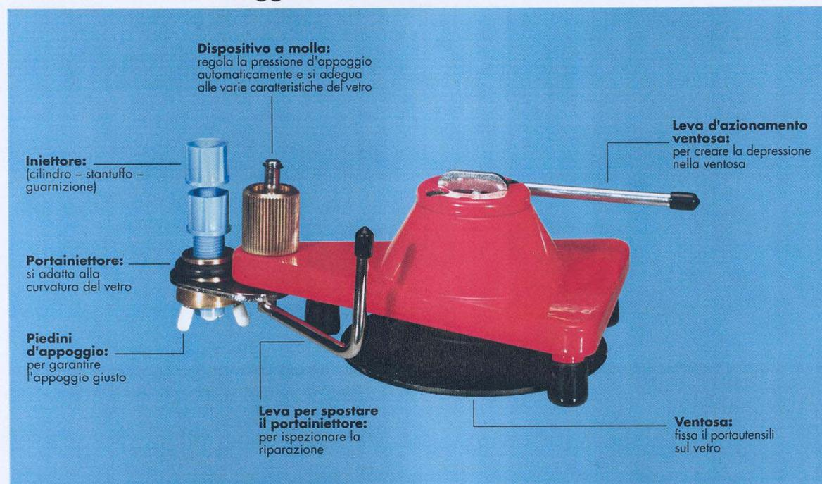
Per ottenere risultati soddisfacenti raccomandiamo di esercitarsi su di un parabrezza prova prima di effettuare riparazioni sui veicoli. Per creare una rottura tipo (pietrisco) si può usare la sfera in acciaio contenuta nel set, lanciandola mediante l'elastico sul parabrezza (fionda).
