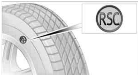
I pneumatici con caratteristiche di emergenza si riconoscono dal simbolo circolare con le lettere RSC presente sul fianco del pneumatico.
