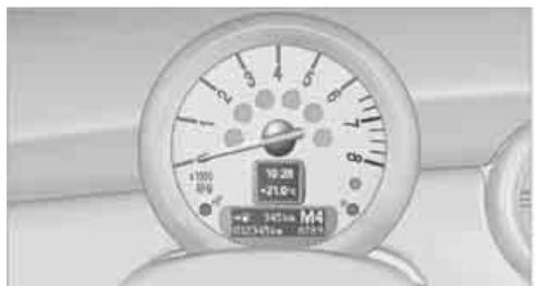
Evitare assolutamente i regimi compresi nel settore rosso. In questa zona, per proteggere il motore viene interrotta l'alimentazione di carburante.
