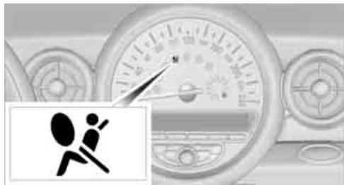
A partire da radio in stand-by, pagina 44, la spia di avvertimento si accende brevemente per indicare che l'intero sistema airbag e il pretensionatore sono operativi.
