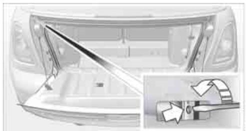
3. Attraverso il cacciavite svitare la vite dorata, vedi freccia, in direzione della freccia ruotandola di circa un giro e mezzo.
