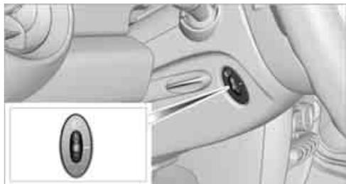
È necessario adeguare manualmente la profondità del fascio luminoso degli anabbaglianti in base al carico della vettura, in modo da non abbagliare i veicoli provenienti in senso contrario.
