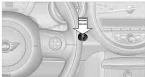
Premere il pulsante start/stop per inserire e disinserire la radio in stand-by oppure l'accensione. Non premere contemporaneamente né freno né frizione.
