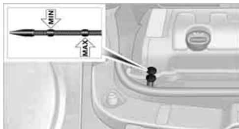
La quantità d'olio fra le due tacche dell'asta di misurazione è di circa 1 litro nel motore benzina e di 1,5 litri nel motore diesel.
