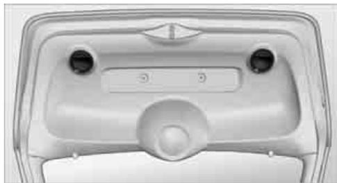
Le maniglie ricavate nel rivestimento interno del cofano posteriore consentono di abbassare con più facilità il cofano stesso.
