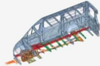
Dispersione delle forze sul gruppo motopropulsore
