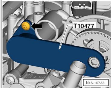
Estratta la vite -freccia-, togliere il dispositivo di fissaggio -T10477-.
