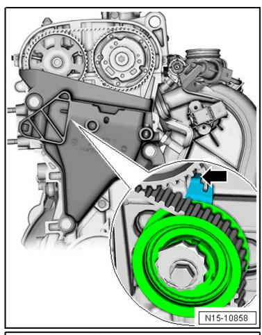
La superficie fresata della ruota dentata - freccia- deve poggiare sulla superficie fresata del perno dell'albero motore.
