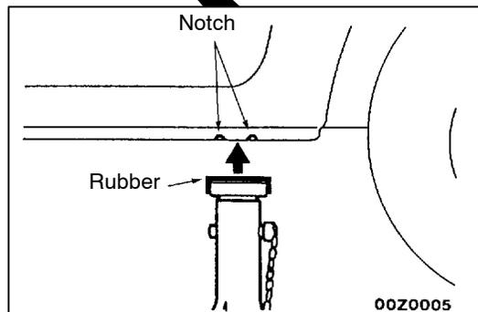
**SUPPORT POSITIONS FOR A SINGLE-POST LIFT OR DOUBLE-POST LIFT**
