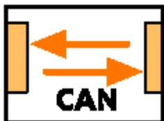
**Tramite le linee CAN BUS, la centralina porta conducente, invia l'informazione alle altre centraline del sistema comfort; contemporaneamente, comanda il bloccaggio della propria porta.**
