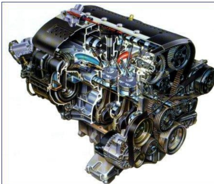
Fig. 1.28: Motore Alfa Romeo JTS
