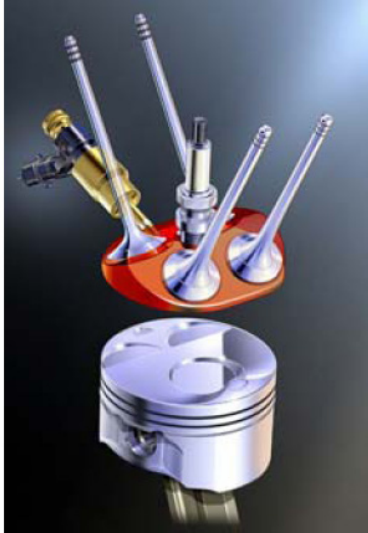
Fig. 1.30: Stantuffo e testata del JTS.
