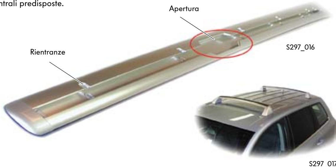
I tiranti contengono un meccanismo di tensione chiudibile: se la serratura è aperta e la valvola è sbloccata i supporti vengono spinti nella posizione desiderata. Quando la valvola e la serratura vengono chiuse i supporti sono fissati. I supporti possono essere arrestati solo nella zona delle rientranze.
