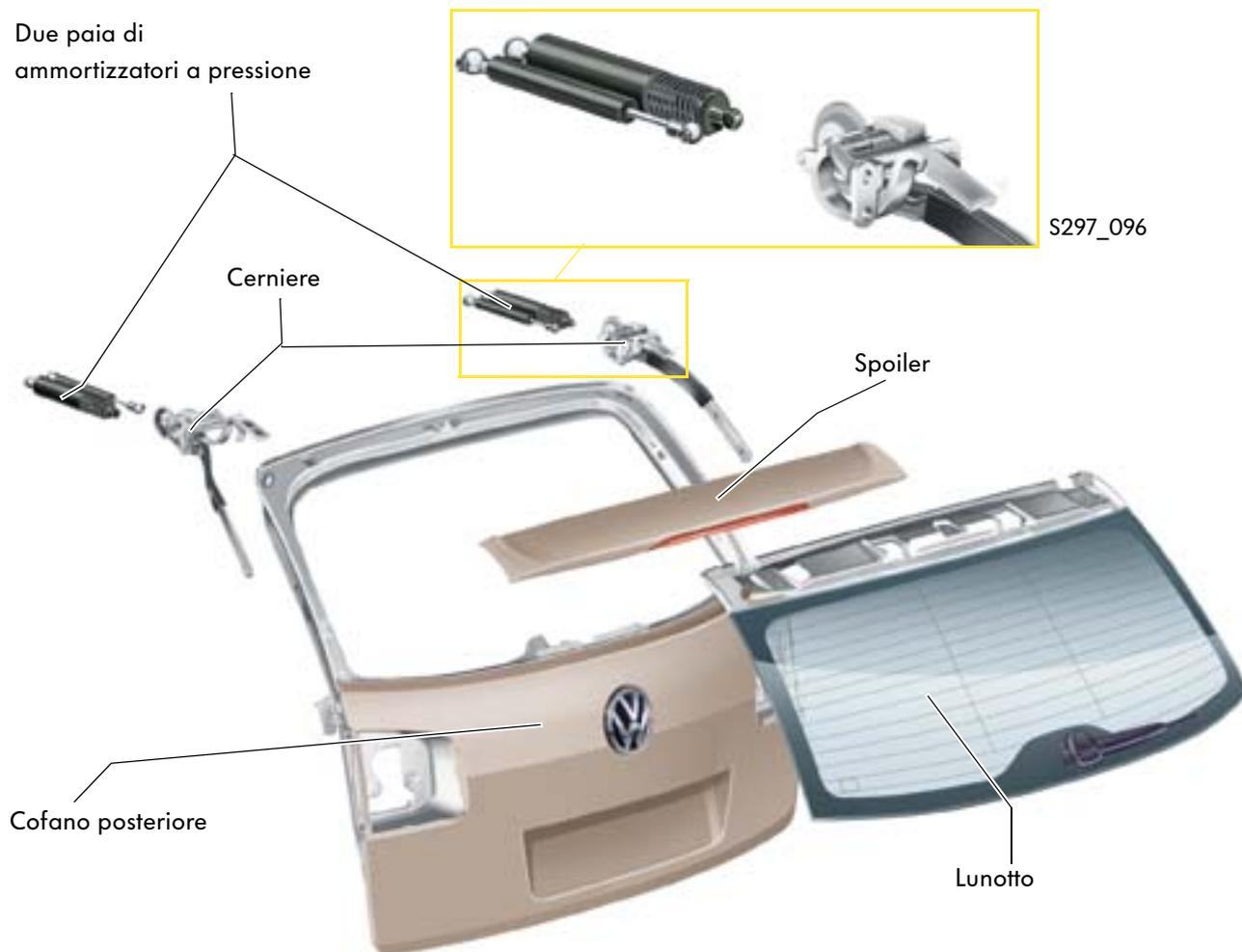
Alla comoda apertura e chiusura del lunotto e del cofano posteriori provvedono due paia di ammortizzatori a pressione montati all'interno della carrozzeria e invisibili dall'esterno.
