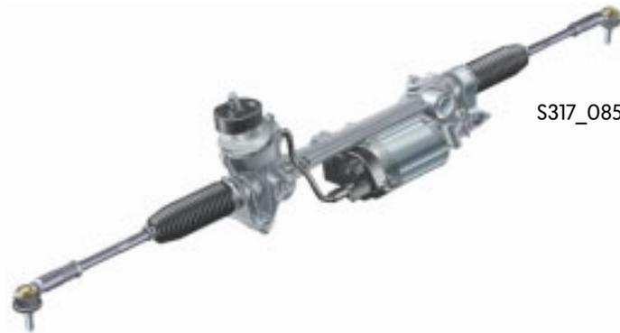
La scatola guida è costituita dal sensore della coppia di sterzata, una barra di torsione, un pignone di sterzata e un pignone conduttore, un ingranaggio a vite e un motore elettrico con centralina. Il cuore del servosterzo elettromeccanico è rappresentato dalla cremagliera con due denti ingranati nella scatola guida.
