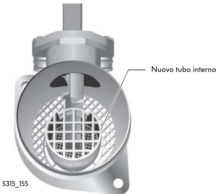
Verificando la plausibilità del misuratore massa aria a termopellicola si possono riconoscere i seguenti guasti:
