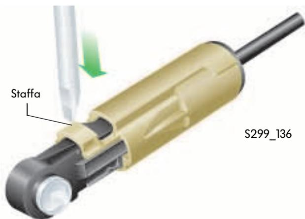
Per serrare i cavi di selezione e di innesto, è necessario sganciare il rispettivo dispositivo d'arresto all'interno della scatola della leva. A tal fine premere con il cacciavite sulla staffa del dispositivo di blocco del cavo di selezione ovvero di innesto.
