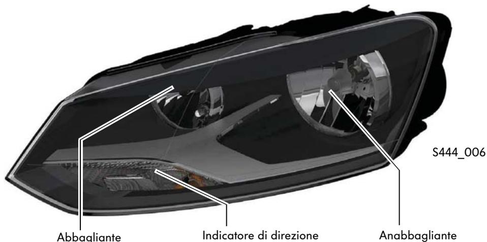
I fari della Polo 2010 possono essere smontati con gli attrezzi di bordo. Ciò è necessario poiché le lampadine si possono sostituire solamente con il faro smontato.
