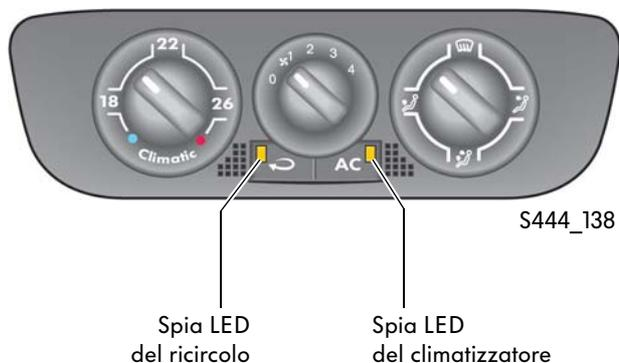
La centralina del Climatic J301 si trova dietro gli elementi di comando del climatizzatore. Tutti i segnali dei sensori e degli attuatori vanno alla centralina dove vengono analizzati per la regolazione della temperatura interna.
