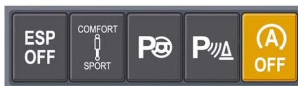
Il tasto della funzione Start/Stop F416 è installato al posto della manopola di comando della regolazione adattiva dell'assetto DCC.
