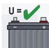
La batteria è in grado di fornire la quantità di energia necessaria alla riaccensione del motore (che è stata calcolata prima con la "predizione della tensione di avviamento").
