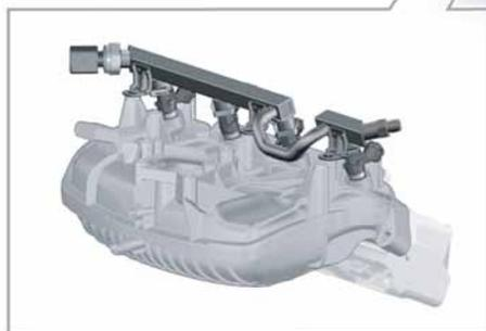
**Collettore di distribuzione con valvole di insufflazione del gas 1 - 4 N366 - N369 e sensore del collettore di distribuzione del gas G401**
