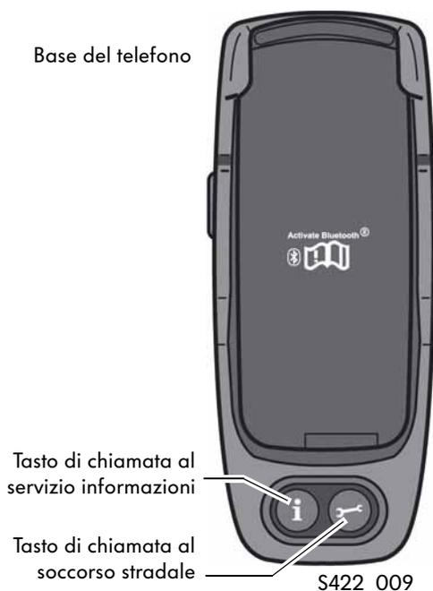
Il modulo GSM è integrato nella centralina del sistema elettronico dei comandi del telefono e collegato all'antenna esterna, che ha una potenza maggiore. In tale modo si ottiene una ricezione praticamente esente da interferenze. Il telefono cellulare deve essere tuttavia correttamente registrato nell'UHV (si vedano le informazioni relative all'accoppiamento Bluetooth®).
