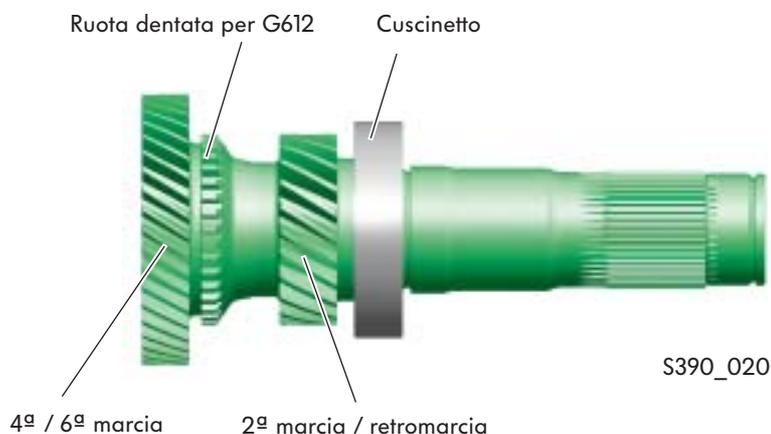
L'albero primario 2 è cavo. È unito alla K2 mediante un collegamento ad innesto dentato. L'albero primario 2 consente l'innesto della 2ª, 4ª, 6ª marcia e della retromarcia. Su questo albero è situata la ruota dentata del sensore 2 del numero di giri in entrata del cambio G612.
