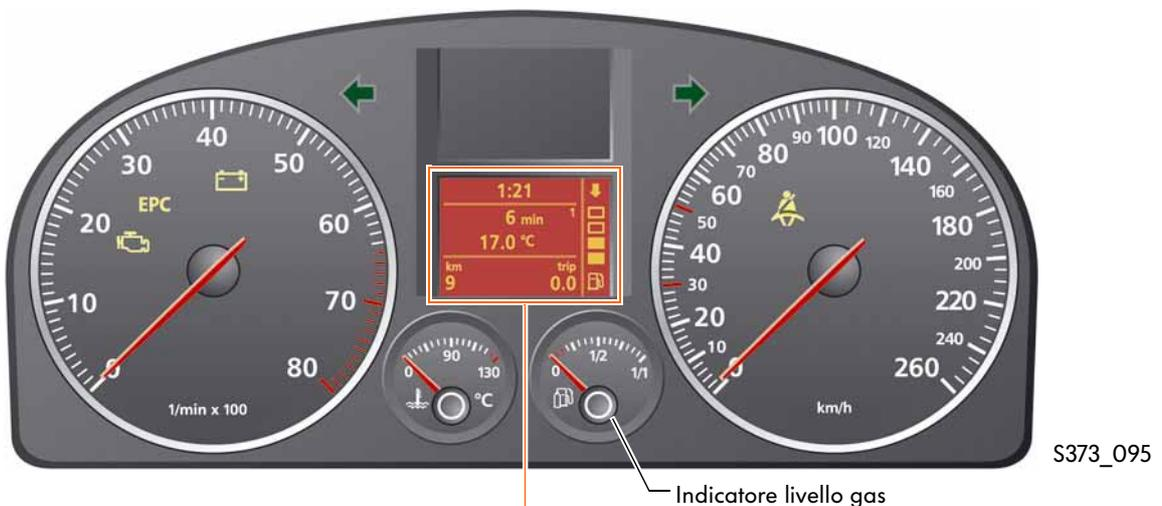
Se si accende la freccia accanto o sopra alle barre di indicazione il motore sta funzionando a benzina. Quando la freccia si spegne il veicolo è tornato a funzionare a gas.
