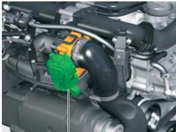
Unità di comando valvola a farfalla J338 con sensore d'angolo del comando di apertura farfalla G187 e G188 S359\_050
