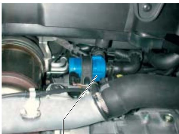
Pompa circolazione del liquido di raffreddamento V50
