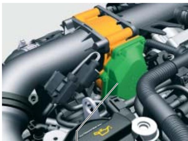
Unità di comando della valvola di regolazione J808 con potenziometro della valvola di regolazione G584 S359\_052
