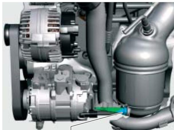
Sonda lambda G130 con riscaldamento sonda lambda Z29
