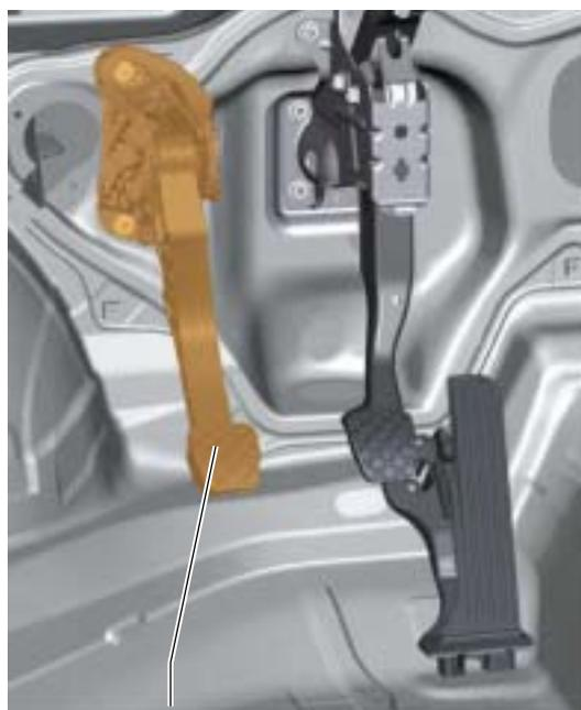
Pedale frizione con sensore di posizione frizione
