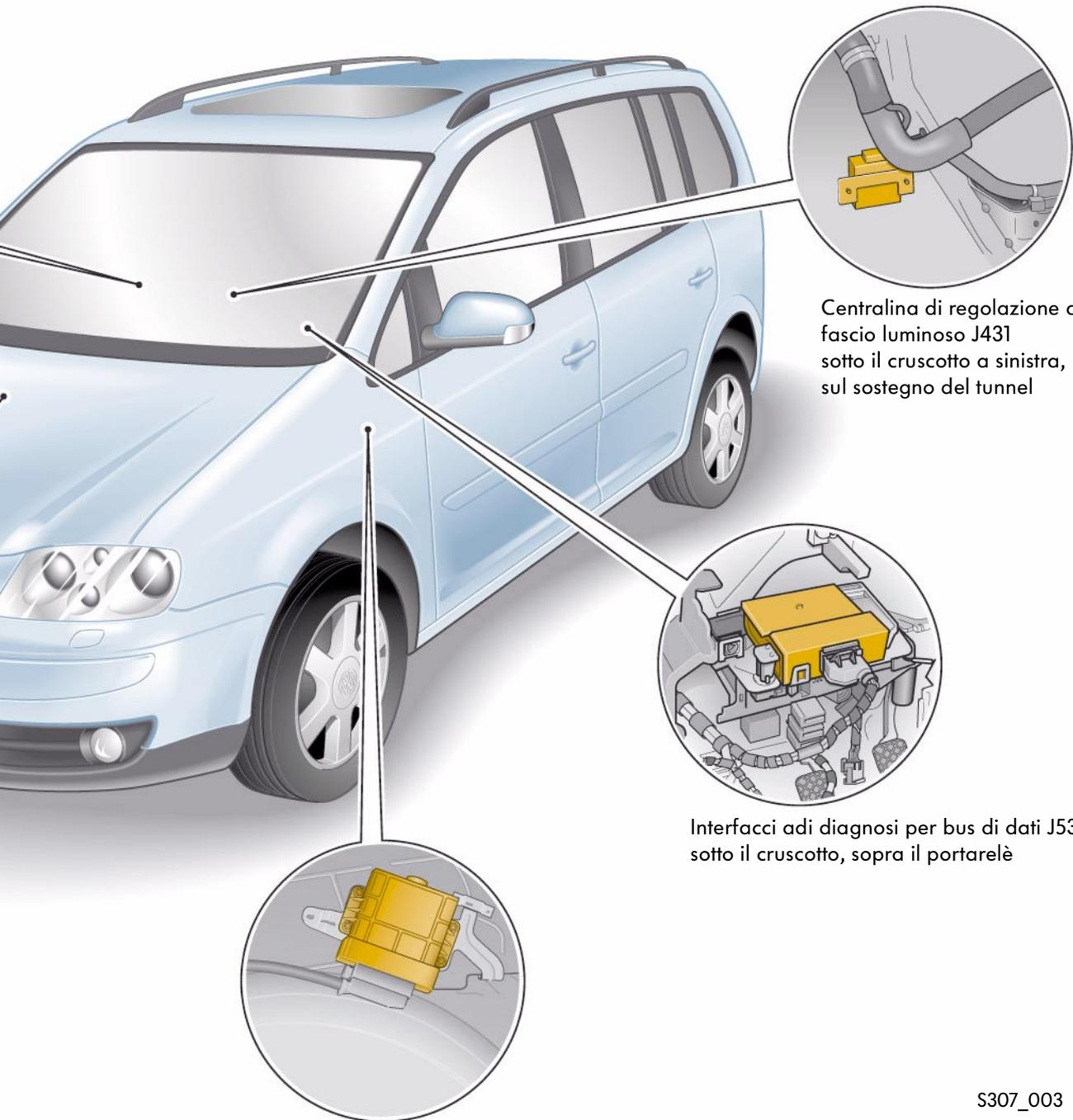
Centralina di regolazione del fascio luminoso J431 sotto il cruscotto a sinistra, sul sostegno del tunnel
