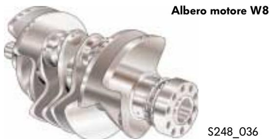
L'albero motore dei motori W viene realizzato con acciaio di bonifica mediante fucinatura a stampo. In mezzo a ogni coppia di cuscinetti principali sono alloggiati due bielle.
