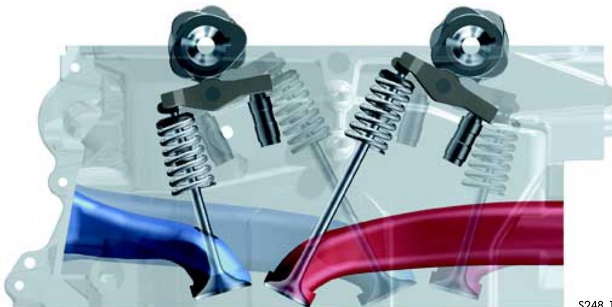
In base alla disposizione dei cilindri, si alternano valvole lunghe e corte e canali di aspirazione e di scarico lunghi e corti.
