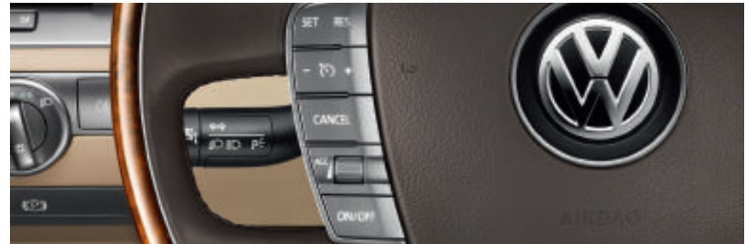
A partire dalla velocità di 30 km/h l'impianto di controllo della velocità mantiene la velocità impostata costante, aumentando il comfort di guida soprattutto nei lunghi viaggi.
