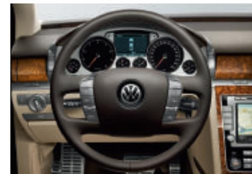
Il nuovo volante multifunzionale in pelle scalda le mani nelle giornate più fredde. Dispone di tasti di comando integrati per la radio, il cellulare, il display multifunzionale, il comando vocale e l'impianto di controllo della velocità.
