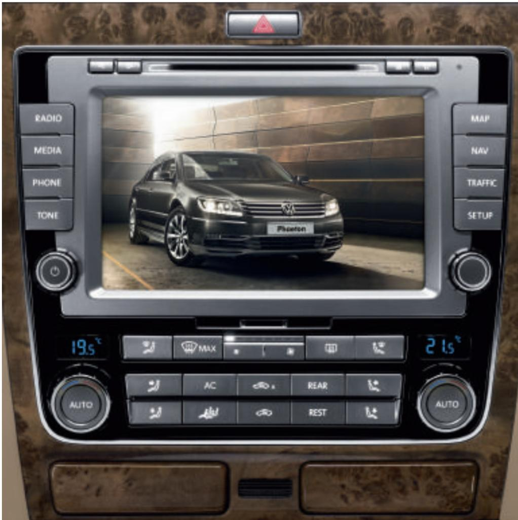
La **ricezione TV** a vettura ferma consente di disporre, oltre alla televisione analogica, anche di quella digitale (DVB-T), in ottima qualità video ed audio. In caso di segnale mancante o troppo debole il tuner commuta automaticamente alla ricezione analogica.
