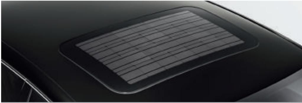
Il **tettuccio solare scorrevole/reclinabile**: le cellule solari integrate alimentano l'impianto di ventilazione anche a motore spento, abbassando in modo notevole, nelle giornate calde, la temperatura all'interno della vettura.
