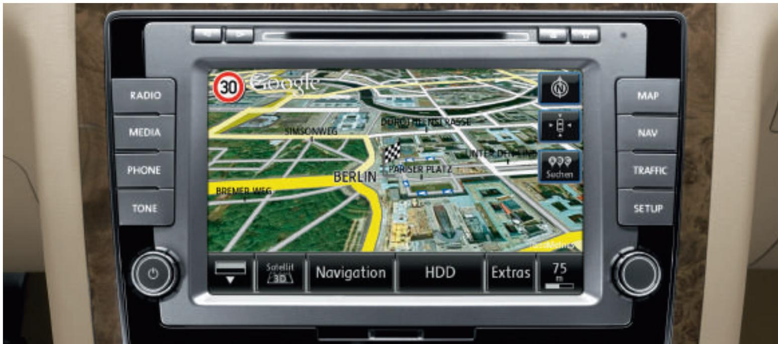
Il fascino della tecnica: il nuovo sistema di radio-navigazione “RNS 810”, completo di predisposizione per l'utilizzo di servizi Online\* detta nuovi criteri per intrattenimento mobile e ti consente, per la rappresentazione delle mappe di navigazione, l'accesso online alle immagini satellitari Google. La ricerca locale Google online di destinazioni specifiche offre, inoltre, la massima attualità e tante informazioni in più.
