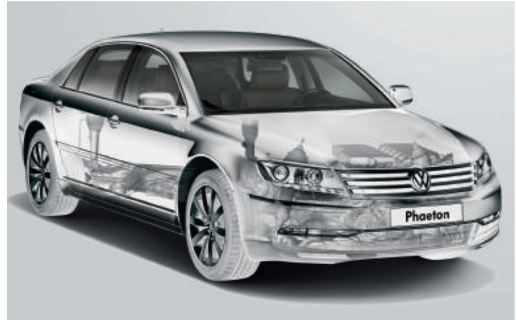
Con il propulsore a 12 cilindri più compatto del mondo **Phaeton W12** si presenta da vera regina delle limousine di lusso. Cilindrata da 6 litri, coppia di 331 kW (450 CV) con 560 Nm portano questa berlina ad una accelerazione di appena 6,1 secondi da 0 a 100 km/h. A 250 km/h l'accelerazione viene limitata elettronicamente, senza togliere nulla al piacere di guida di Phaeton W12.
