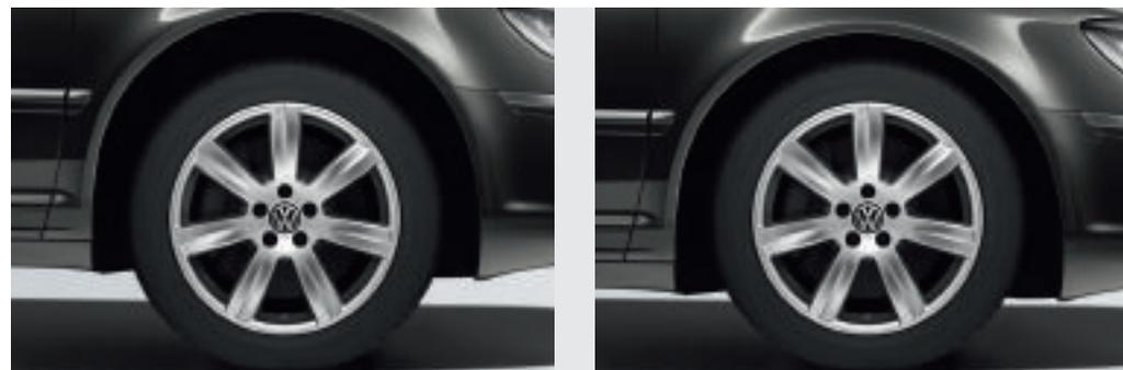
All'occorrenza la **sospensione pneumatica a regolazione elettronica** alza l'assetto fino a 25 mm, assicurando anche sui terreni più sconnessi il massimo comfort di guida. A velocità elevata l'assetto si abbassa automaticamente fino a 15 mm, al fine di ridurre al massimo la resistenza all'aria.
