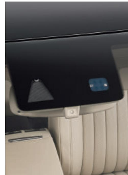
Nel parabrezza è integrata una **videocamera multifunzionale** che rileva i segnali e le immagini per la ricognizione della segnaletica stradale o per il sistema di regolazione dinamica degli abbaglianti. Il modulo comprende anche il sensore della pioggia (di serie).
