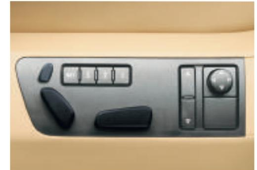
Il **pacchetto Memory** per la regolazione a 12 vie memorizza la posizione della seduta, del piantone di guida, dello specchietto retrovisore interno, dello specchietto retrovisore esterno e delle cinture di sicurezza.
