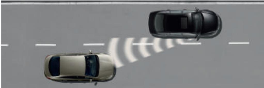
L'assistente al cambio di corsia “Side Assist”: già a partire da una velocità di 30 km/h il sistema individua i veicoli nell'angolo cieco e ti informa, tramite un segnale visivo nello specchietto retrovisore esterno, della presenza di eventuali pericoli.
