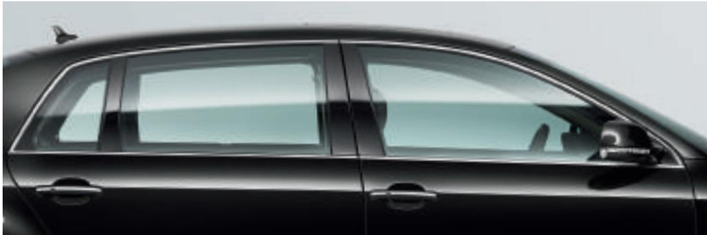
Il **vetro isolante** provvede ad un piacevole clima all'interno della vettura, riducendo l'eccessivo calore dell'abitacolo a temperature esterne elevate e creando un clima di benessere per i passeggeri. Nell'utilizzo di un impianto di climatizzazione si riduce, inoltre, il consumo di carburante, in quanto l'energia richiesta per raggiungere la temperatura desiderata all'interno della vettura è notevolmente ridotta.
