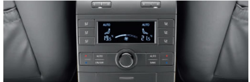
L'impianto di climatizzazione a 4 zone Climatronic, di serie, può essere integrato di un altro elemento di comando per la parte posteriore (optional) e consente in tal caso il comando dell'impianto clima da tutti e cinque posti sedili.
