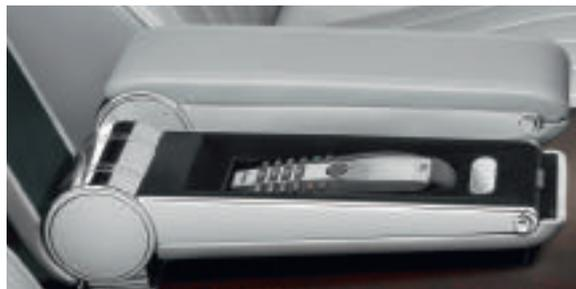
La predisposizione per il telefono cellulare "Premium" con tecnologia Bluetooth® consente la trasmissione particolarmente veloce dei dati UMTS tramite il modulo del telefono. A richiesta può essere abbinata ad un auricolare di comando/ascolto Bluetooth®. Ogni funzione avviene tramite il riconoscimento vocale o il sistema Infotainment.
