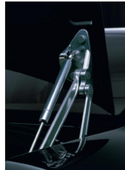
Il portellone del vano di carico ad apertura e chiusura elettronica può essere comandato dall'interno, grazie al sistema integrato di motorizzazione elettrica, direttamente dalla strumentazione di bordo della vettura.
