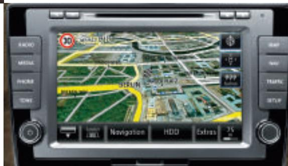
Il nuovo sistema di radio-navigazione "RNS 810", completo di predisposizione per l'utilizzo di servizi online\* consente l'accesso online alle immagini satellitari Google per la rappresentazione delle mappe di navigazione. Una ulteriore novità è costituita dal rilevamento della segnaletica per il traffico: un limite di velocità – anche in caso di pioggia, viene registrato tramite videocamera, confrontato con i dati di navigazione ed infine segnalato sul display, se rilevante per il tuo percorso.
