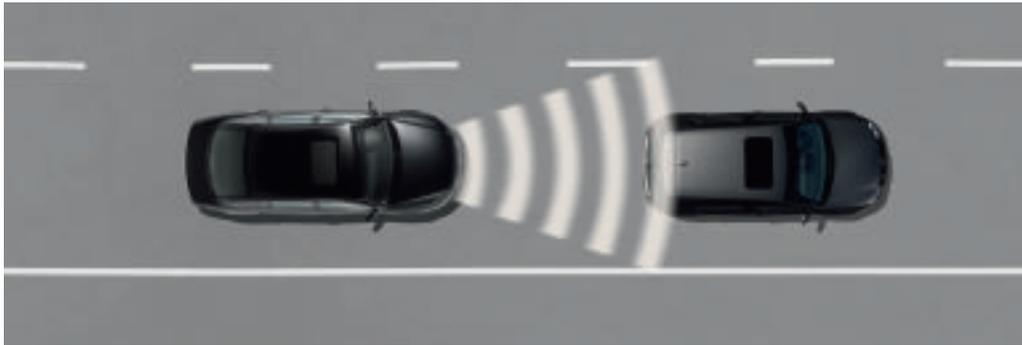
Il sistema di controllo automatico della distanza ACC ed il sistema “Front Assist” adeguano la velocità impostata dal conducente a quella del veicolo che ti precede ed assicurano il mantenimento costante della distanza. Se il “Front Assist” rileva un avvicinamento eccessivo, lo segnala in due fasi: prima con un avvertimento ottico ed acustico, poi con una breve frenata di preavviso.
