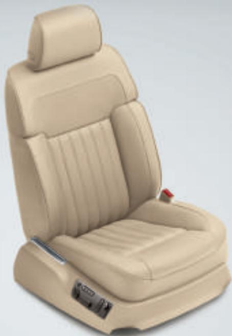
Nei sedili anteriori con regolazione a 12 vie la seduta, l'inclinazione di seduta e schienale, il supporto lombare e la profondità possono essere regolati elettricamente e in tutta comodità con l'unità di comando collocata sul lato esterno del sedile.
