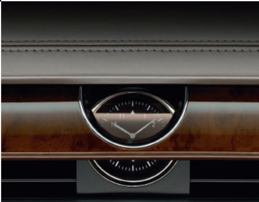
Gli inserti in legno coprono le bocchette di ventilazione del Climatronic a 4 zone. Si alzano temporaneamente, come un sipario, per consentire di raggiungere rapidamente la temperatura desiderata, e, tramite alimentazione d'aria indiretta, rendono la climatizzazione dell'interno praticamente priva di correnti d'aria.
