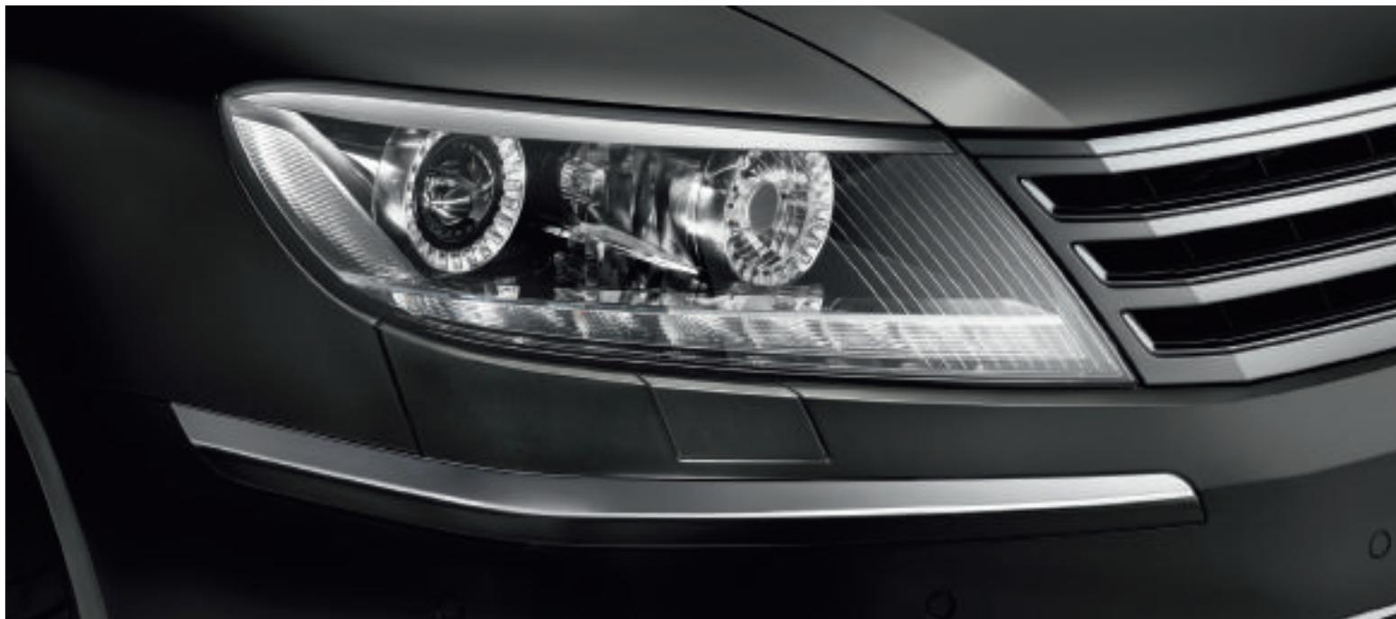
I **proiettori Bi-Xeno con luce in curva adattiva a LED e luce diurna a LED** dispongono di piccoli motori che orientano i fari sempre nella direzione di guida, migliorando l'illuminazione della corsia e, in particolare, del ciglio della strada nelle curve. Nella svolta viene attivata anche la luce statica a LED che assicura maggiore visibilità nella zona immediata adiacente al veicolo. Una luce diurna a LED si attiva automaticamente all'avviamento della vettura.
