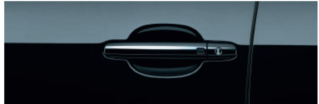
Il **sistema di chiusura ed avviamento senza chiavi "Keyless Access"**: al contatto con la maniglia l'elettronica della vettura comunica con la chiave, sbloccando le portiere e attivando il pacchetto Memory, anche quando la tua chiave si trova ancora nel taschino o nella borsetta.
