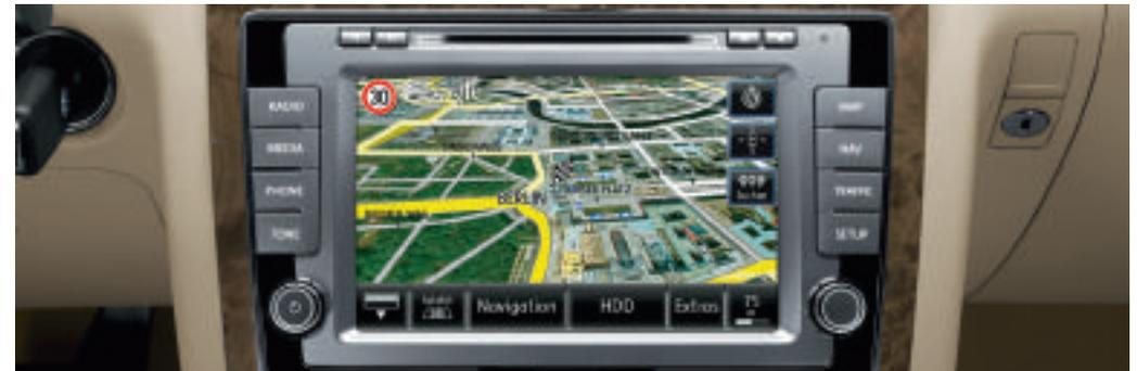
Il sistema di radio-navigazione "RNS 810" dispone di un sistema di riconoscimento della segnaletica stradale: un limite di velocità viene registrato da una videocamera e indicato sul display multifunzionale. Un confronto automatico con i dati di navigazione provvede ad informarti solo dei limiti più importanti. Inoltre vengono rilevate anche informazioni supplementari – come i limiti di velocità in caso di pioggia/manto stradale bagnato o quelli riguardanti solo veicoli al traino.
