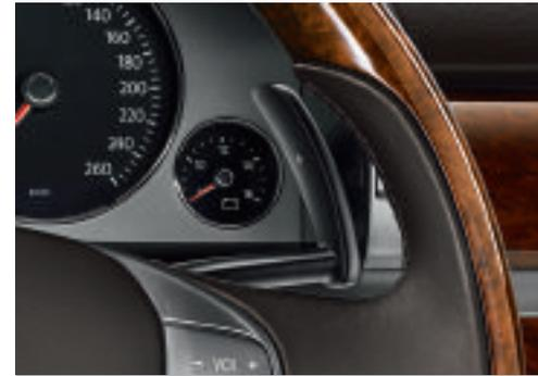
Le leve del cambio collocate al piantone dello sterzo rendono il comando Tiptronic particolarmente ergonomico e consentono il cambio marce manuale, molto simile a quello utilizzato dai piloti di formula 1.
