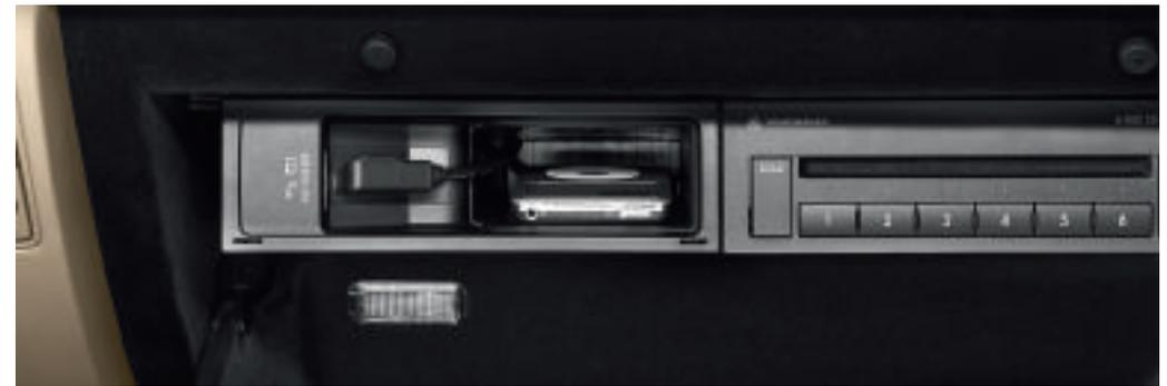
La **presa multimediale MEDIA-IN** consente, attraverso un'interfaccia USB, la riproduzione di file audio da memorie dati e lettori MP3 con certificazione USB. Con un cavo adattatore supplementare puoi collegare, inoltre, un Apple iPod® a partire dalla quarta generazione.
