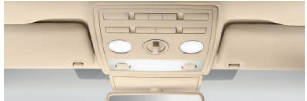
L'apricancello del garage è integrato in una console del padiglione della vettura e può essere impostato sulla frequenza di comando del cancello elettrico del tuo garage nonché su quella di altri due impianti.
