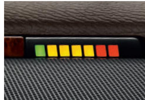
Il **sistema di controllo della distanza** aiuta il conducente nelle manovre di parcheggio segnalando lo spazio rimanente anteriore e posteriore che lo separa da altri veicoli o ostacoli. Il sistema informa il conducente con segnali ottici ed acustici.
