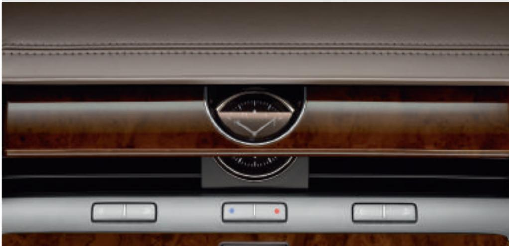
Nella modalità automatica le **bocchette d'aria** dell'impianto di climatizzazione Climatronic a 4 zone si aprono e si chiudono in modo autonomo.
