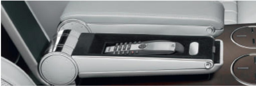
La predisposizione per il telefono cellulare "Premium" con tecnologia Bluetooth® (Remote SIM Access Profile/rSAP, Hands-Free-Profile) consente la trasmissione particolarmente veloce dei dati UMTS tramite il modulo del telefono. A richiesta può essere abbinata ad un auricolare di comando/ascolto Bluetooth®, versatile come un cellulare e, nel tempo stesso, facile da usare come un comune telefono. Ogni funzione avviene, comodamente, tramite il riconoscimento vocale o il sistema Infotainment.
