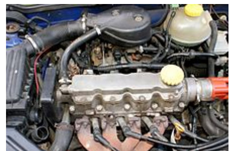
Motore con chiave ottani visibile in alto a sinistra (95 ottani)
